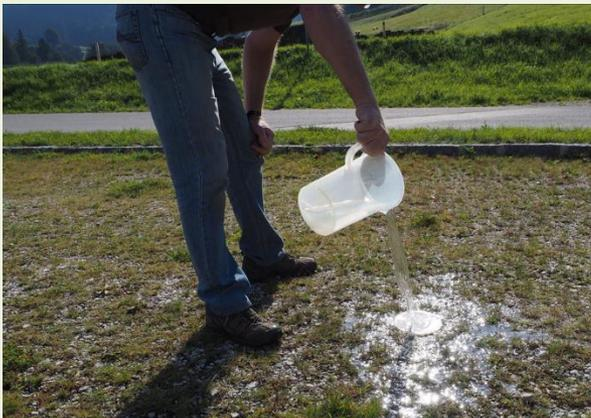
Prallplatte 15cm  $\varnothing$ , 3 Ausschüttversuche mit 2l Wasser, Versickerungszeit: 30-100 Sekunden durchlässig bis schwach durchlässig
